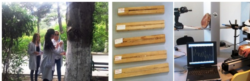
Рис. 2. Взятие кернов, сушка извлеченных образцов и дендрохронологический анализ.
