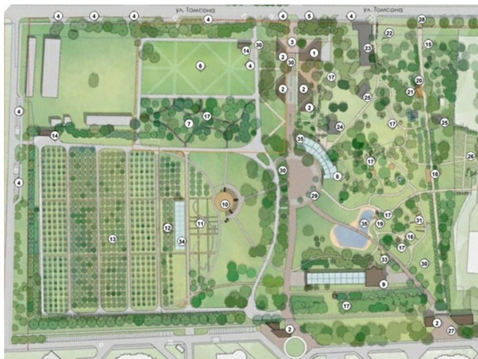
Рис. 6. Современный Генеральный План к концепции восстановления и реновации «Сада Томсона» (Шлёнова, Красильников, Маяренков и др., 2017). Эмпликация: 1. Музей имени А. К. Томсона с административными помещениями; 2. Торгово-выставочный павильон; 3. Главный вход с улицы Томсона; 4. Открытая автомобильная парковка; 5. Стоянка для автобуса; 6. Площадка для ярмарок; 7. Дендрологическая коллекция; 8. Оранжерея; 9. Учебный корпус с теплицей; 10. Амфитеатр; 11. Учебно-экспериментальная площадка; 12. Научно экспериментальная площадка; 13. Питомник; 14. Хозяйственный корпус; 15. Мемориальная доска; 16. Садовые перголы; 17. Беседка; 18. Терраса для праздничных мероприятий; 19. Причал/видовая площадка; 20. Историческая беседка (воссоздание); 21. Фонтан на месте исторического колодца; 22. Вход в погреб; 23. Существующее здание Россельхозцентра; 24. Существующая котельная; 25. Существующий склад; 26. Экспериментальный огород; 27. Вход с улицы Розы Люксембург; 28. Исторический вход; 29. Центральная площадь; 30. Сад ароматных трав; 31. Аптекарский огород; 32. Сад плодово-ягодных культур; 33. Детская ландшафтная площадка; 34. Теплица; 35. Водоем и коллекция водных растений. Автор концепции: В. М. Шленова. Авторы архитектурного проекта: А. Красильников, С. Маяренков, Д. Кремлёва, В. Казакова, О. Семина, А. Репина, П. Заславская.
